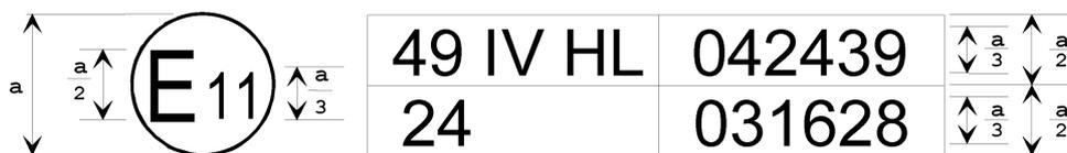
Il marchio di omologazione sopra riportato, apposto su un motore/veicolo, indica che il motore/veicolo è stato omologato nel Regno Unito (E11) in forza del regolamento n. 49 (livello di emissione IV) e del regolamento n. 24 <sup>(1)</sup>. Le prime due cifre del numero di omologazione indicano che, alla data in cui sono state rilasciate le omologazioni, il regolamento n. 49 comprendeva la serie 04 di emendamenti e il regolamento n. 24 la serie 03 di emendamenti.
